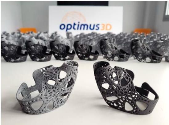
Ortesis de dedo pulgar para tratamiento de rizartrrosis fabricadas mediante tecnología aditiva en material PA12.
