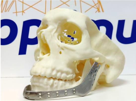
Placa de osteosíntesis implantable a medida de Ti6Al4V sobre biomodelo de ABS.
